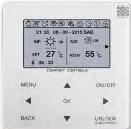
L'unità di controllo remoto è costituita da una **centralina elettronica digitale dotata di un ampio display grafico** e tasti touch di impostazione e viene collegata via cavo all'unità interna fino ad una distanza massima di 50 metri.
